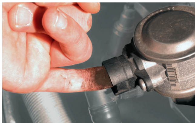
Rapide contrôle du clapet d'air secondaire dans la BMW 520i (mis en évidence)
