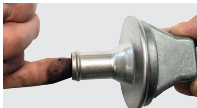
Figure 1: Simple contrôle du clapet anti-retour
